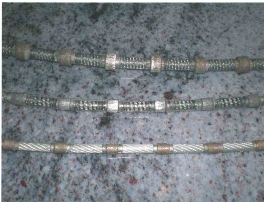
Die Tendenz ist eindeutig – es geht zum immer dünneren Seil. Von oben nach unten: 11 mm-, 8 mm- und 6 mm-Seil mit Kunststoffverspritzung
