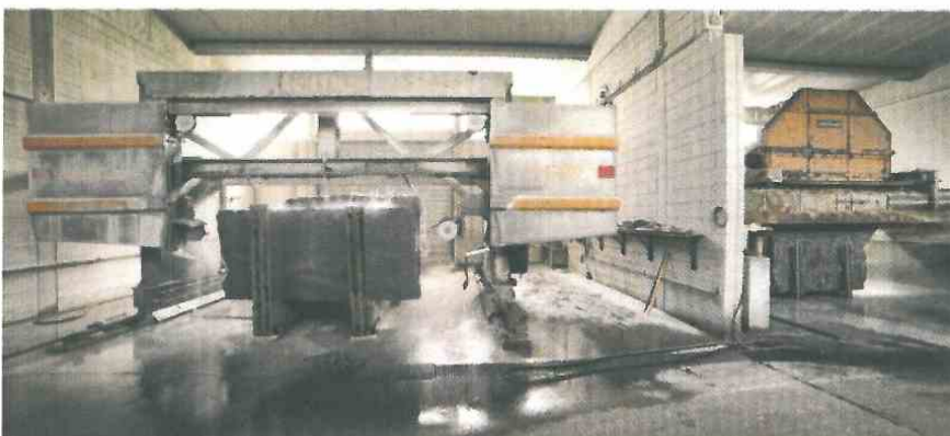
Zwei Giganten in einer Halle: Löffler Horizontalseilsäge mit 2-m-Seilrädern und eine Blockkreissäge
