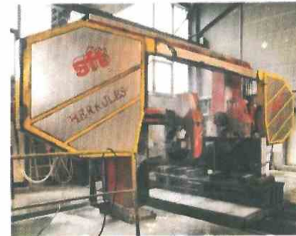
Unverwüsthliche Herkules: Die SFT-Konturen-seilsäge verarbeitet die Tranchen aus der Blocksäge-rei für die eigene Kollektion »Memento«.
